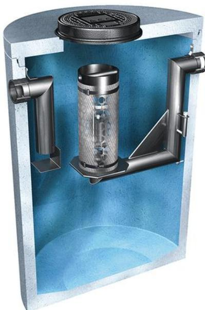
Slika 12. Vertikalni presjek ACO Oleopatora C-FST
